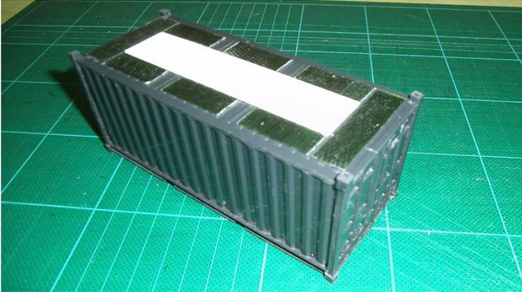
Auf die gegenüberliegende Stirnseite als die Türseite wird eine Klappe simuliert mit eine Streife PS mit darauf 2x das L Profil und 1 x das U Profil.
